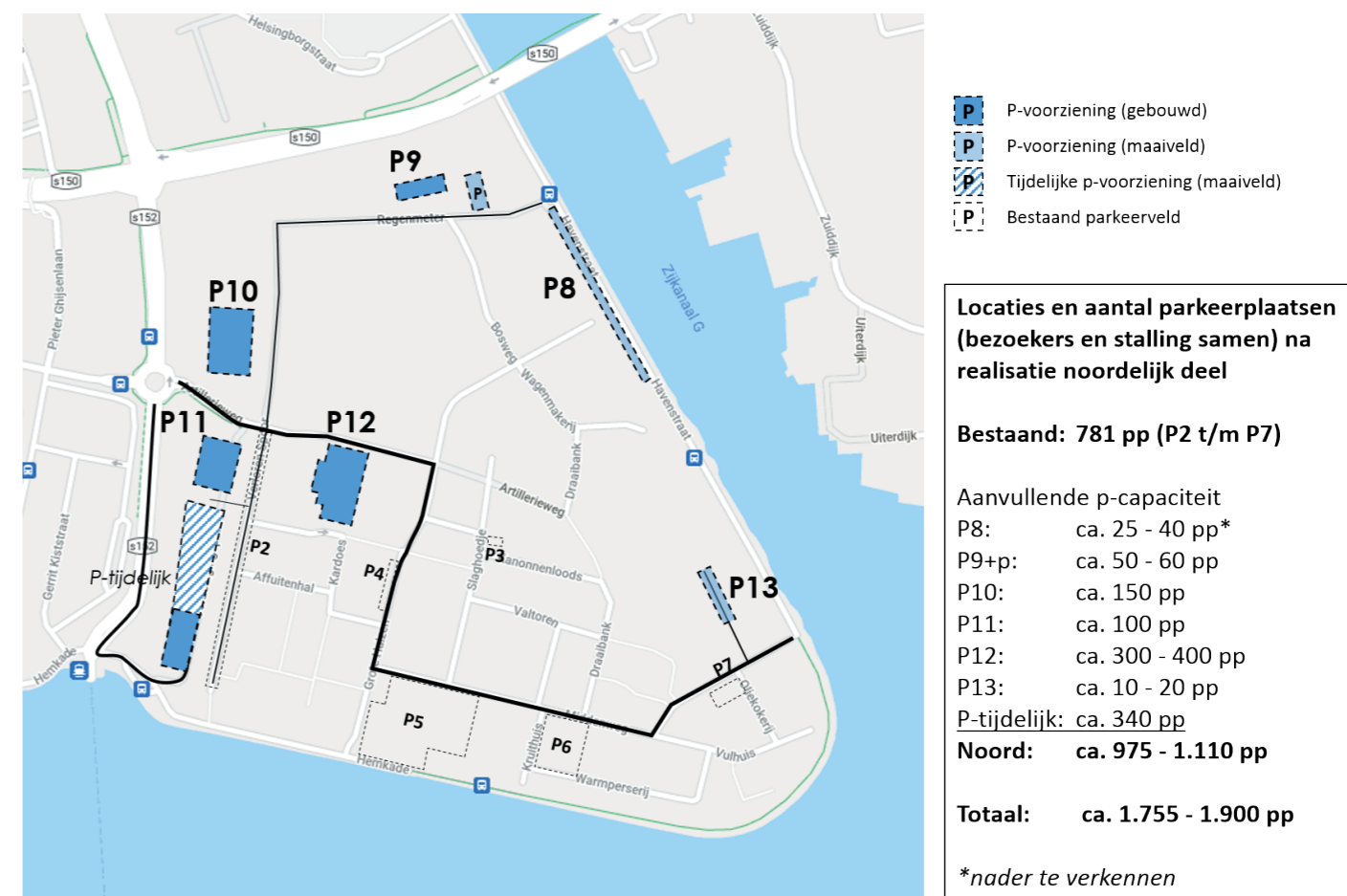
Figuur 33: (Uitbreiding van) parkeervoorzieningen Hembrugterrein als gevolg van de ontwikkeling van het noordelijk deel.
